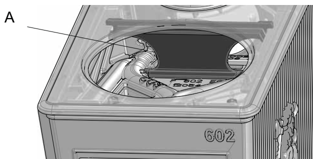
Fig. 27 Remplacement du déflecteur d'évacuation
