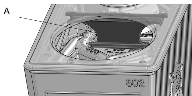
Fig. 27 Sustitución del deflector de escape
